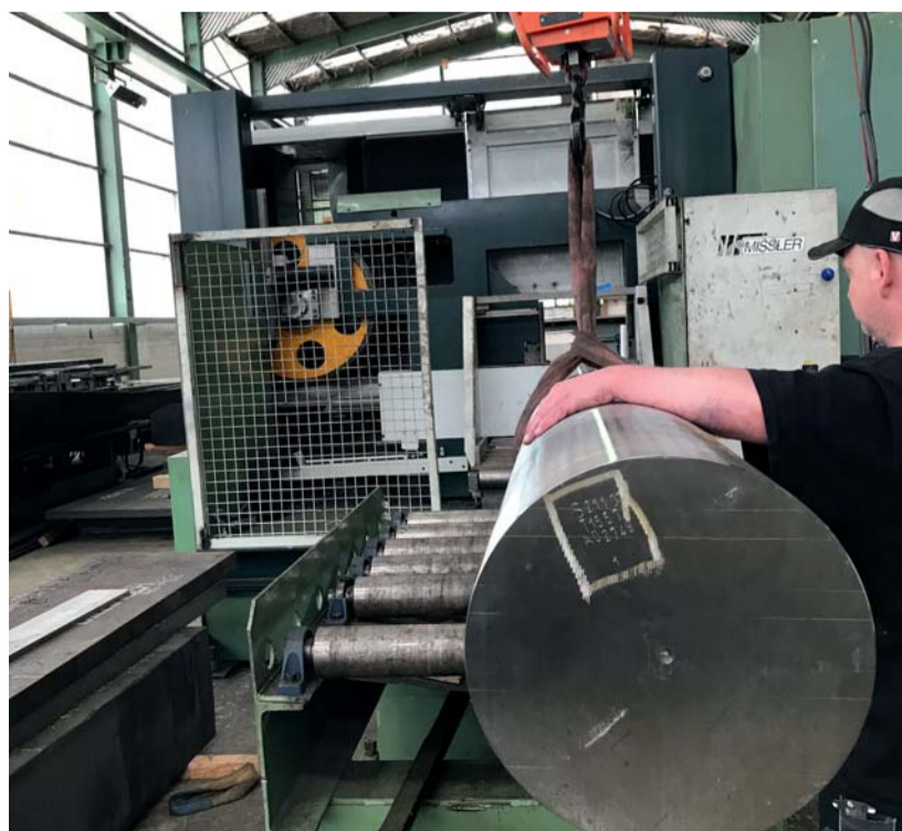
Basedo 3: Ein 355,6 mm Rundstahl in 1.4410 auf dem Weg in den Sägepark
